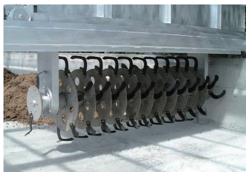
固液分離機によって分けられた固形分に副資材を加えて堆肥を作る自動攪拌機「ファームクリーン」
