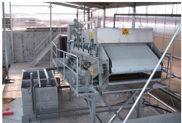
家畜の排泄物を液体と固形に分ける固液分離機「Wコンベアー」
