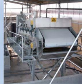
固液分離と加圧脱水機と2枚の濾布が合体したWコンベアー。2枚の濾布で汚泥を挟み込む加圧脱水によって、含水率80%前後が可能。
