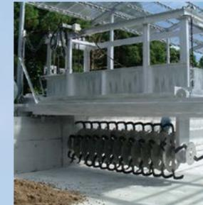
畜産ユーザーのニーズにこたえる！低コストで、故障の少ないシンプルな攪拌機処理装置。
