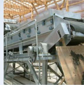
スクリーンコンベアーS処理後の2次脱水機。スクリーンコンベアーS・アフタープレスのセット処理によってトータスコスト削減。
