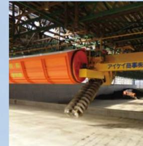
3mの発酵槽に対応する深型タイプの攪拌機。高容積・省スペース、静かで効率的な畜ふん発酵処理が可能。
